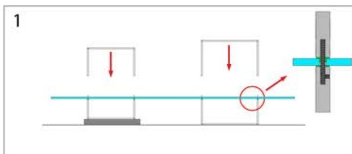
**1.** posizionare i telai delle alzatine superiori a terra con i perni filettati rivolti verso l'alto. Mettere uno spessore di 4 cm. sotto l'alzatina piu' bassa per pareggiare le altezze. Inserire le apposite ranelle di protezione in teflon nei perni e posizionare il vetro.
