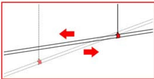
**1.** Forare il soffitto ed inserire il tassello in dotazione. Fissare il supporto con le viti in dotazione ed infilare il cavo in acciaio di sospensione. Regolare all'altezza desiderata.
