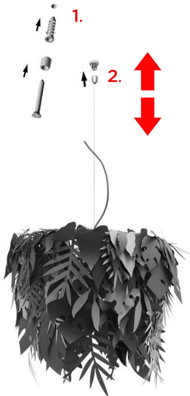
1. Forare il soffitto, inserire il tassello in dotazione e avvitare la base filettata del supporto
