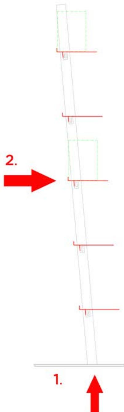
**1.** Avvitare la base alla Scala con le viti in dotazione.
