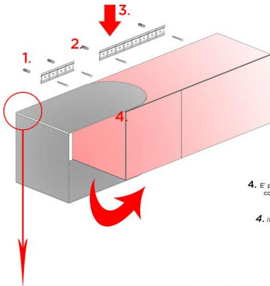
1. Mettere in bolla la barra di supporto nella posizione desiderata e segnare i punti di foratura per l'inserimento dei tasselli a muro
