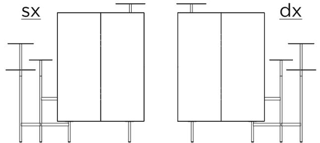
1. Scegliere il lato dove posizionare il telaio, FORARE (punta  $\varnothing 6$ ) DALL'ESTERNO VERSO L'INTERNO utilizzando come riferimento il preforo presente mostrato nella figura
