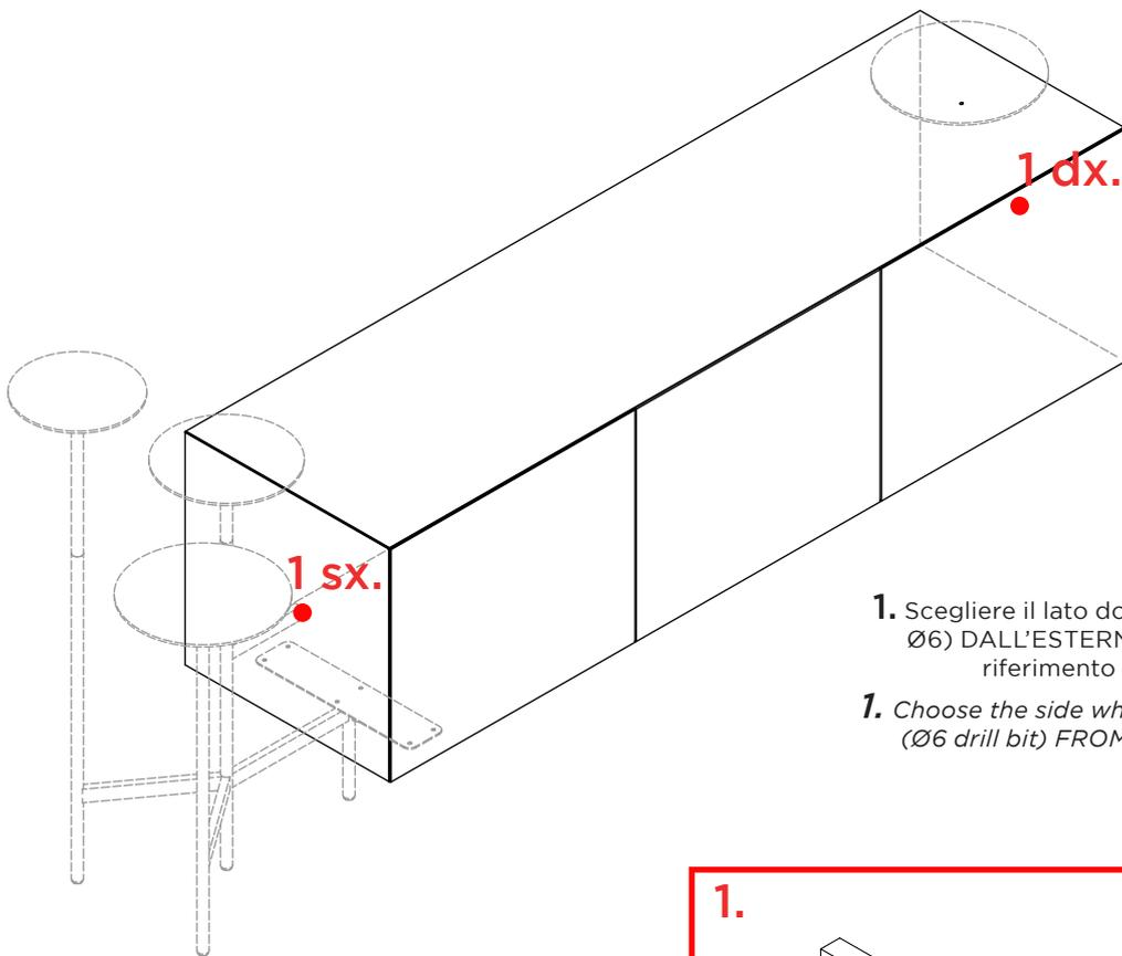
1. Scegliere il lato dove posizionare il telaio, FORARE (punta Ø6) DALL'ESTERNO VERSO L'INTERNO utilizzando come riferimento il preforo presente mostrato nella figura
